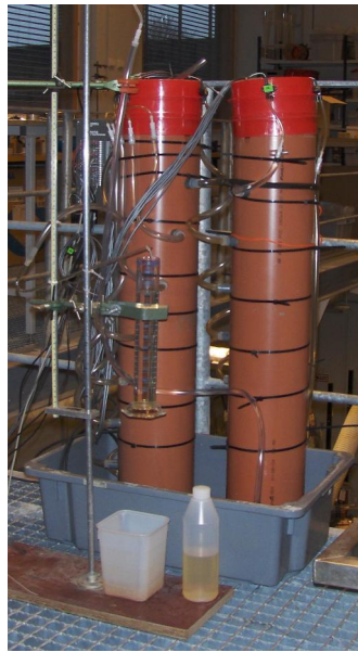
Kuva 7. Kyllästymättömän vedenjohtavuuden mittaamiseen käytetty laitteisto. Kuvassa kaksi maakolumnia vierekkäin.
