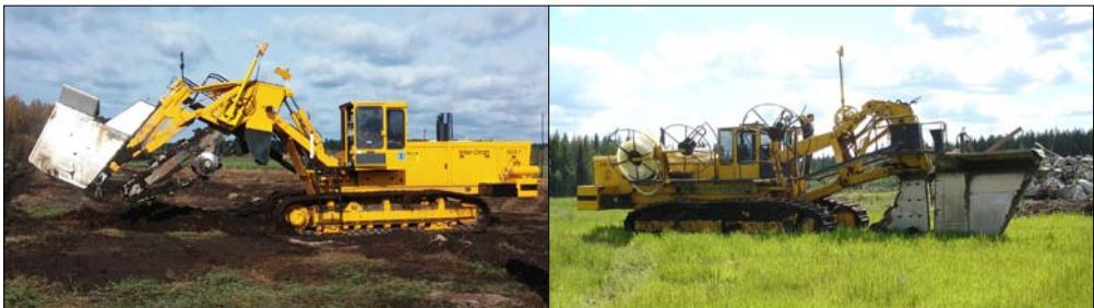
Kaivava ja aurasalaojakone.
